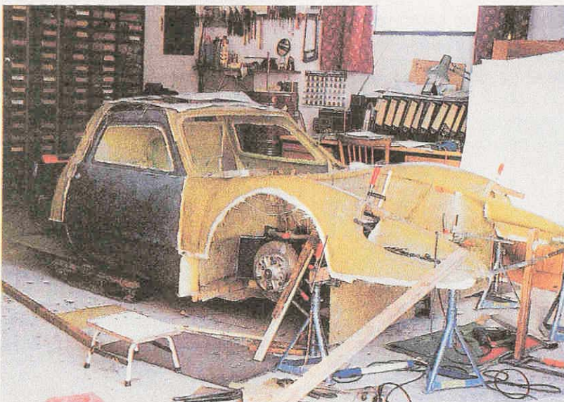
Eine Achse, wie aus dem letzten Fahrerlager ausgebrochen: doppelte Querlenker vorn und hinten
